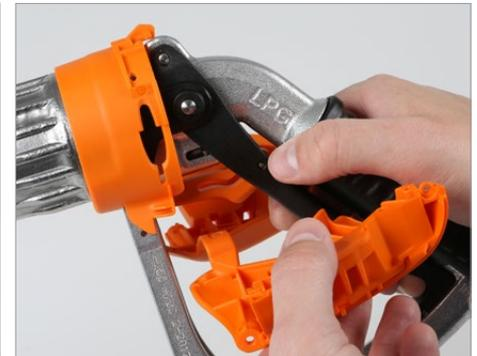
Schalthebel aufrasten, Schutzüberzug Seitenteile EK 867 SSG hindurchführen.
