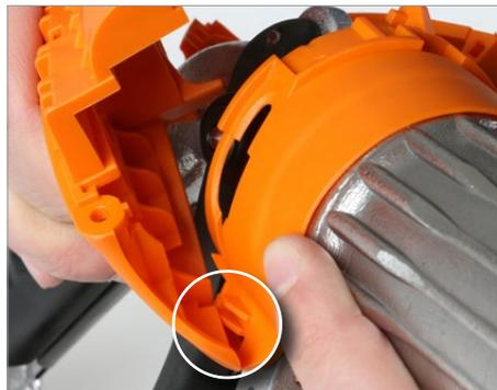
Schutzüberzug Vorderteil und Schutzüberzug Seitenteile miteinander verbinden. Dafür unten die Kante in der Kerbe und oben die Nase in der Aussparung positionieren.
