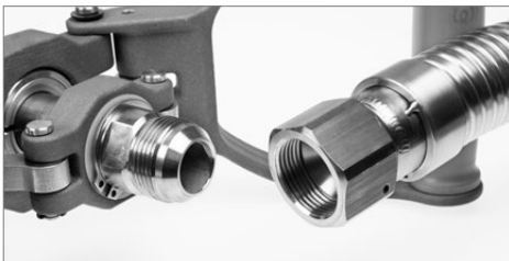
Anschlüsse müssen in Typ und Größe übereinstimmen, z.B. 1 5/16"-12 SAE J514 37° JIC AG/IG.
